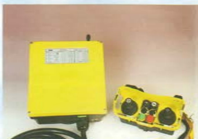
► Mod. SAGA-J: 14 Salidas configurables, 5 velocidades. Ejem. Camiones bombeo hormigón, Grúas plumas, etc. CE-0681
