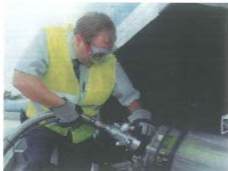
El gas natural se suministra al vehículo bajo presión, mediante un sistema sellado. Una boquilla de repostaje se acopla al depósito del vehículo y el proceso es simple, limpio y seguro.
