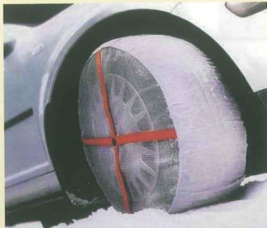
Su aspecto es el de una funda para neumático, sin partes metálicas.
