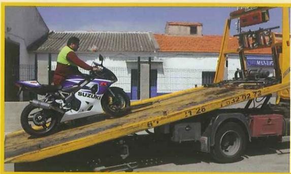
Si no se dispone de mando, ponemos la primera velocidad en la moto y bajamos la pata de cabra. Engancharemos otra eslinga en la rueda trasera bien tensada y sujeta a la parte trasera de la plataforma para fijar la moto. Una vez hecho esto procederemos a poner la plataforma en horizontal desde el cajón de mandos de la grúa.
