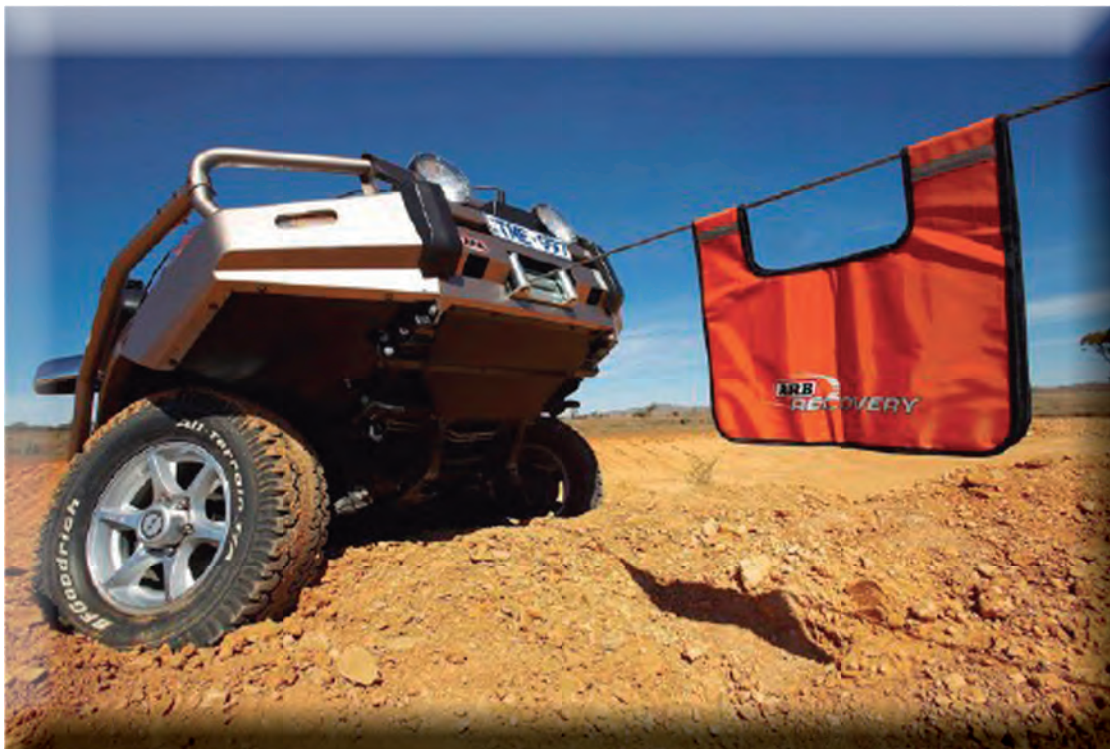
Una simple manta para el cabrestante puede evitar graves daños al operario si el cable se parte.
