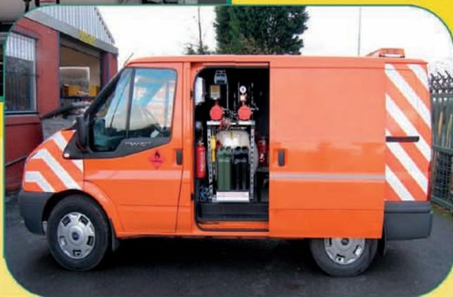
El sistema móvil Scavenger puede ser instalado para puerta lateral o trasera permitiendo a un vehículo taller dar diferentes servicios.
