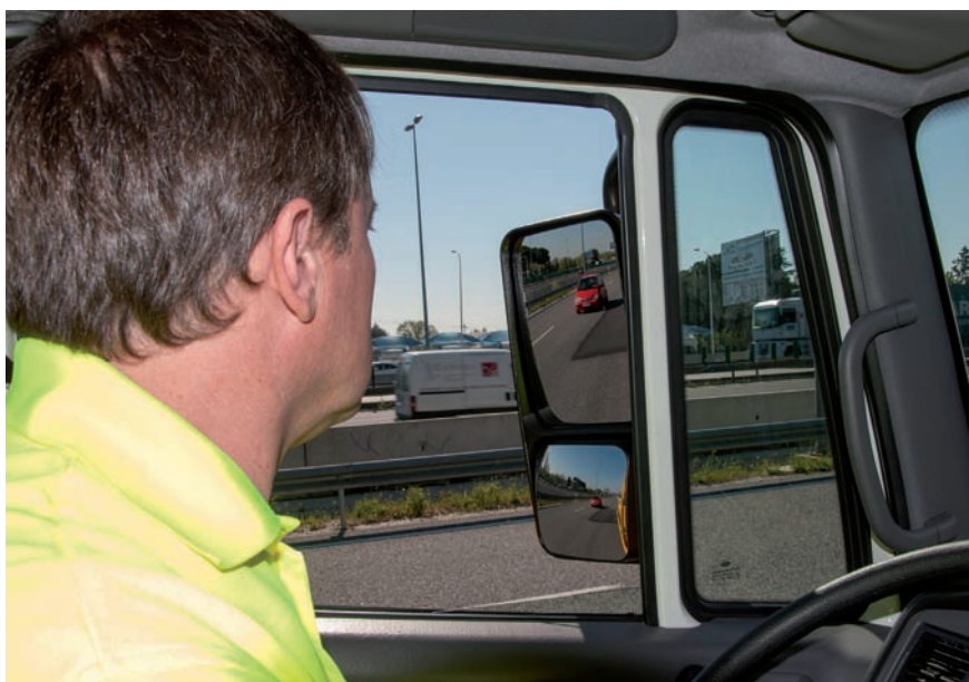
Antes de bajarse de la grúa debemos mirar por el retrovisor.
