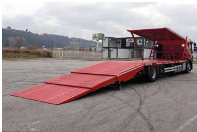
*Plataformas fijas con rampas telescópicas con o sin doble piso.*
